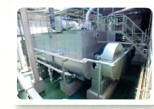
一次発酵装置 下水道汚泥を散気しながら攪拌し、約14日間発酵させます。
