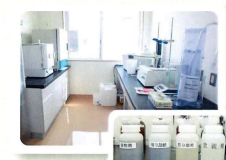
水質検査室 処理水などを分析し、放流基準を満たした安全な水かどうか検査します。
